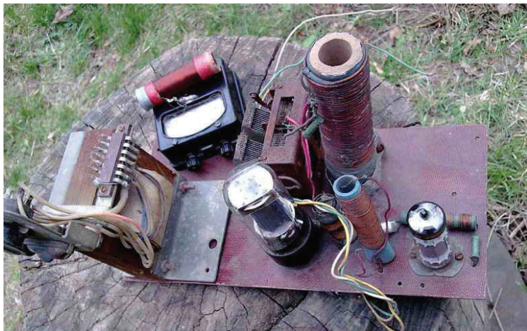
Лампа 6П3С, переменный конденсатор, катушка индуктивности плюс несколько сопротивлений - вот и вся «шарманка» ...
